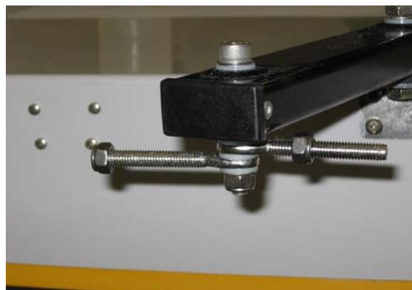
soit d'insérer un écrou frein diam 8 ou de laisser les barres de liaison à poste entre deux navigations. Attention, la fixation du cardan souple ne tiendra bien que si vous respectez le sens du clip (qui est asymétrique).
