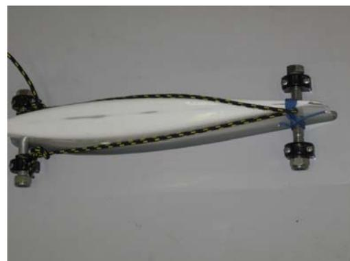
(Kevlar, Spectra ou Dynema) et les tensions uniquement verticales. Le passage horizontal ne sert qu'à empêcher le glissement de la garcette derrière la quille.
