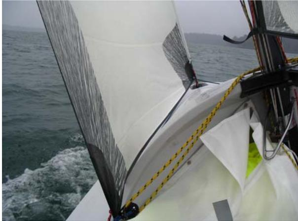
trop fermé, ni trop ouvert), il semble intéressant d'utiliser des repères fixes qui permettront de retrouver le bon réglage. Le chariot de foc à 90 cm de la cloison (dans le prolongement du rail) est un réglage moyen. On reculera le chariot pour faire ouvrir le foc dans la forte brise, on l'avancera pour fermer le haut de la chute sur un bord de débridé. Un marquage de l'écoute, à distance fixe de la poulie ou simplement la façon dont le foc vient
