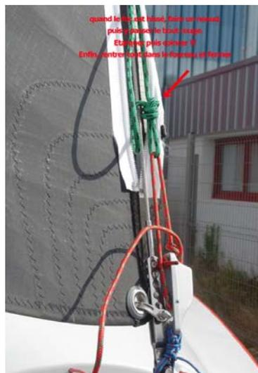
Il faut installer le foc de telle sorte qu'il balaye le pont (effet de plaque), en principe en fixant l'amure sur le second trou en partant du bas. Le manillon sera avantageusement remplacé par une vis diam 5 longueur 22mm et un tour de ruban adhésif (évite de coincer l'écoute de spi lors de l'empennage). La drisse doit être bien grée (cf photos). Tendre la drisse revient à tendre le guindant de la voile
