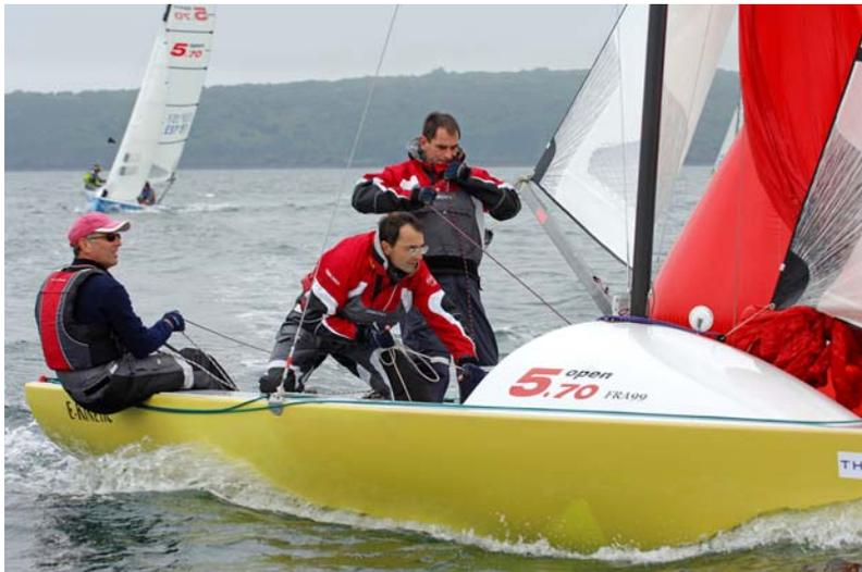
L'envoi de spi se fait toujours sous le vent donc tribord amure. On décroche l'écoute au vent mais surtout pas celle sous le vent.. Un équipier ouvre la baille puis hisse le spi. Lorsqu'il est à mi course, l'autre équipier sort le tangon (et envoi l'amure). Le spi se gonfle alors tout seul. L'écoute sous le vent n'est attrapée et réglée qu'ensuite. Si le bord se fait
